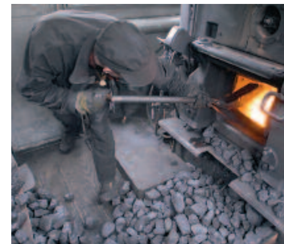
Vieux vapeur du Val-de-Travers: alimentation de la chaudière.
